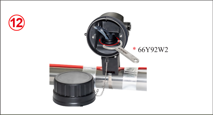
12: 将垫圈放置在脚部上方的凹槽中，然后放在盒子的上面。根据所需的位置调整外壳的方向，然后放置并拧紧带齿的螺母，直到其锁紧为止。
